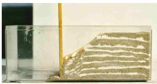
Sucesivas etapas en la generación de una falla normal y de una fosa tectónica o valle rift.
