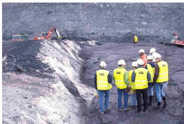
Un plano de falla normal en una mina de carbón a cielo abierto. Los estudiantes están de pie sobre el banco de carbón que ha descendido unos dos metros, deslizándose la masa de roca sobre el plano de falla (gris claro en la foto) en relación con su posición a la izquierda de la imagen. Todas las fotos son de Peter Kennett.
