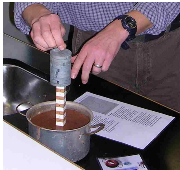
Un maestro muestra como medir la presión en la arena del recipiente. (Foto: P. Kennett)
