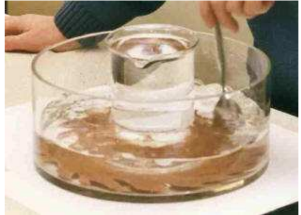
Obtención de ondas asimétricas en un recipiente cilíndrico.
