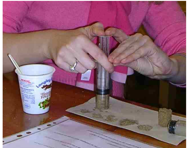
Å lage en avlang og avrundet "stein" av finkornet sand ved hjelp av en sprøyte med avkuttet spiss.
