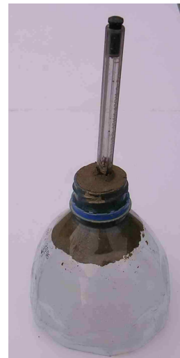
Hjemmelaget trakt laget med toppen av en flaske, røret fra en kulepenn og litt modelleire. (Foto: P. Kennett)
