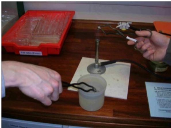
Riscaldamento di porzione di granito -lavoro di squadra! (Foto di Peter Kennett).
