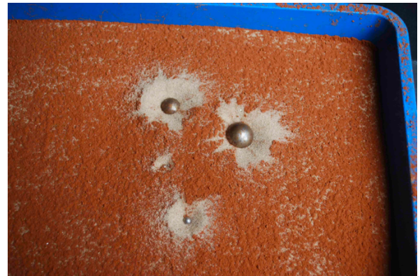
Crateri prodotti facendo cadere 4 sferette d'acciaio di diverse dimensioni in una vaschetta con sabbia spolverata con cacao in polvere.
