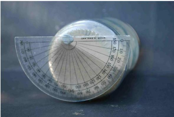
Cómo medir el ángulo de reposo de arena seca. (Nota: Es más fácil usar un transportador tal como se muestra, con la línea de 90° vertical, que con la línea de 0° descansando sobre la mesa).
