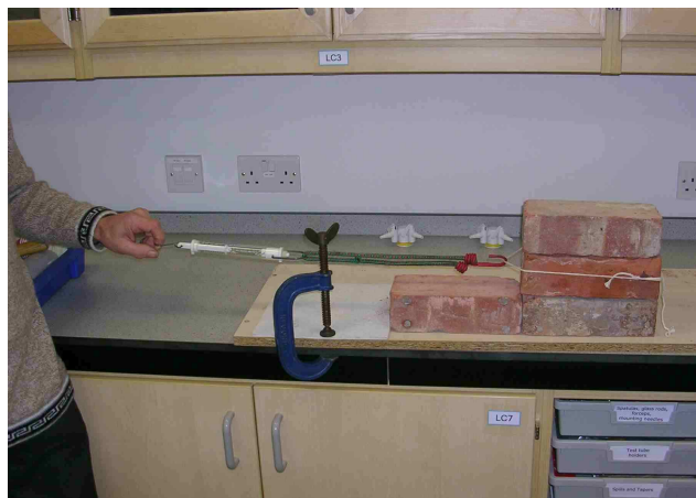
Jordskjelvet inntreffer – b) Bruk et Newtonmeter til å måle kreftene som virker. En fastskrudd plate stopper den fremste mursteinen fra å forflytte seg (Alle foto: P. Kennett)
