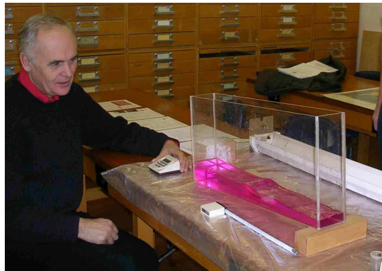
Slik beregnes hastigheten til tsunami i plasttanken. (Foto: P. Kennett)
