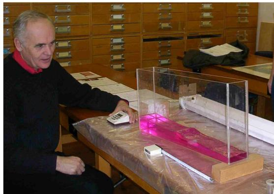
Calcolo della velocità del flusso di uno tsunami in un contenitore di plastica (foto: P. Kennett)
