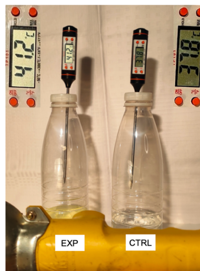
Fig.3 Esposte alla luce di una lampada a incandescenza, le due bottiglie mostrano un diverso aumento di temperatura. (Foto: Giulia Realdon CC BY-SA)
