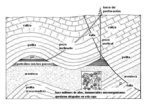
Muestre el diagrama a los alumnos. Explígueles que se trata de un perfil geológico, un corte realizado a través del subsuelo. Explíqueles que el diagrama muestra como se forman los hidrocarburos y como el petróleo y el gas guedan atrapados en el subsuelo. Muestra también como pueden ser explotados, es decir extraídos para su uso.
