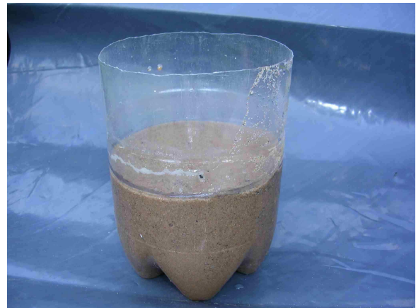
Misurare la porosità di un contenitore pieno di sabbia incoerente
