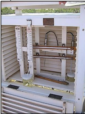
Termómetros de máxima y mínima en un dispositivo de Stevenson, Darwin, Australia.
