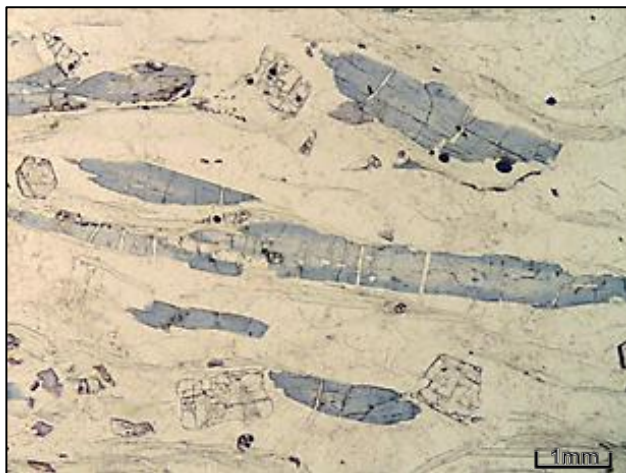
Roca metamórfica al microscopio (sin poros).
