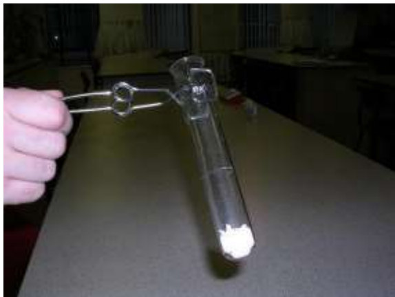
Guix escalfat en un tub d'ebullició Pyrex™, amb gotetes condensant-se a l'extrem del tub. (La flama del Bunsen no es veu en aquesta fotografia). (Foto: P. Kennett)
