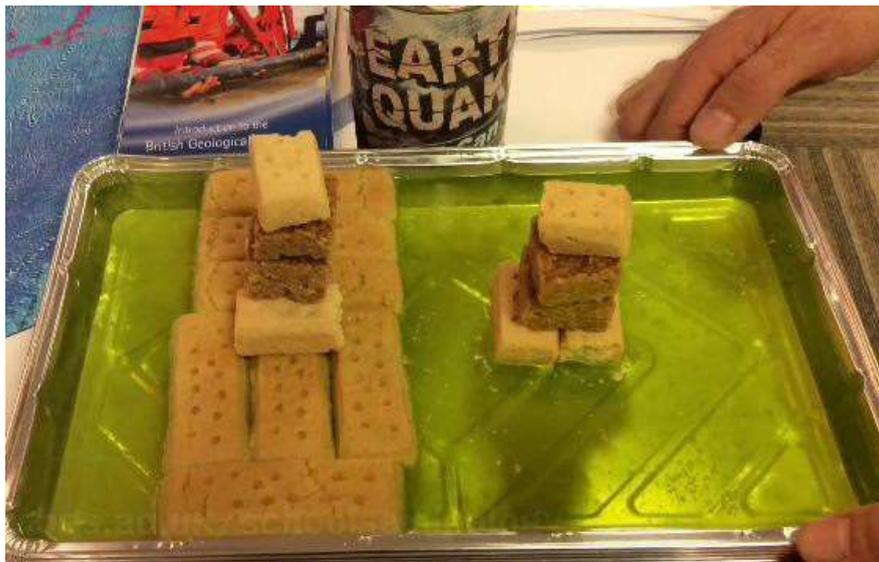
El modelo de gelatina/galleta usado para demostrar la amplificación sísmica local
