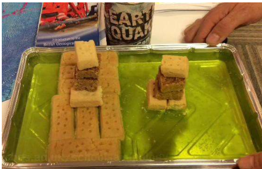
El model de gelatina/galeta usat per demostrar l'amplificació sísmica local (vídeo - http://www.earthlearningidea.com/Video/Mexico_City.html ) (Copyright de foto i vídeo Paul Denton BGS creative commons)
