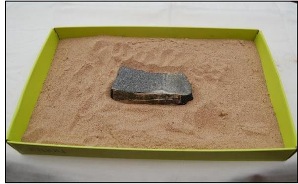
Una roca densa (un trozo de gabro) enterrada en una “roca” menos densa (arena suelta) con una aguja imantada fijada con cinta adhesiva. Cuando se utiliza, la roca está enterrada de manera que solo es visible su superficie superior.
