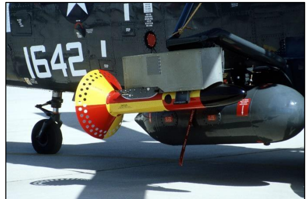
Detector aéreo de anomalías magnéticas en un helicóptero USA.
