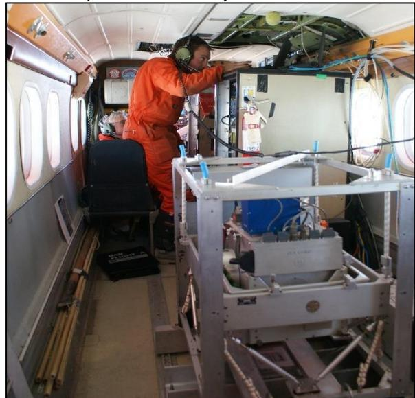
Gravímetro en una aeronave del British Antarctic Survey.
