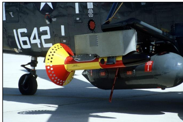
Detector aeri d'anomalies magnètiques en un helicòpter USA.
