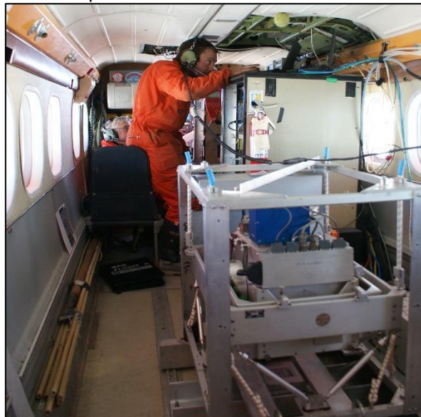
Gravímetre en una aeronau del British Antarctic Survey.
