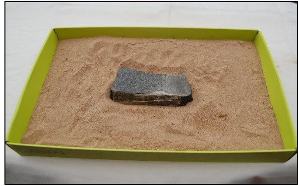
Una roca densa (una peça de gabre) enterrada en una “roca” menys densa (sorra solta) amb una agulla imantada fixada amb cinta adhesiva. Quan es fa servir la roca és enterrada de manera que només la superfície superior és visible.
