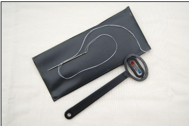
"Magnetòmetre" Magnaprobe™ o agulla imantada amb un fil.
