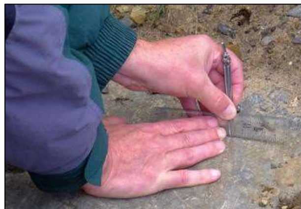
El método usando un compás y una regla para medir la profundidad de las estrías glaciares, Traeth Bychan, Anglesey, GB. (Peter i Maggie Williams).
