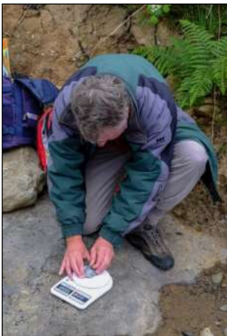
Usant una balança electrònica per mesurar la força necessària per ratllar un còdol de calcària amb un fragment punxegut del till, Traeth Bychan, Anglesey, GB. (Peter Williams).
