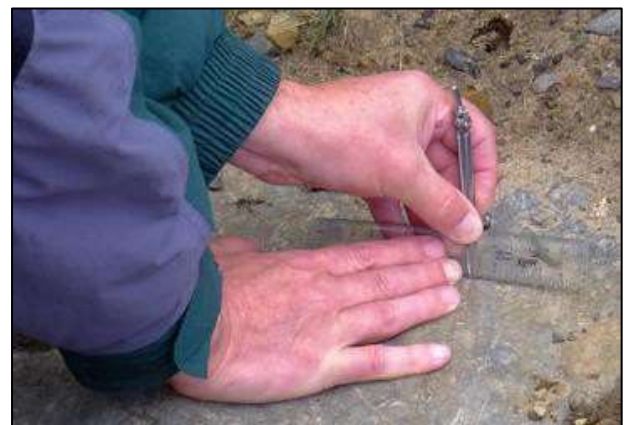
El mètode usant un compàs i un regle per mesurar la profunditat de les estries glacials, Traeth Bychan, Anglesey, GB. (Peter i Maggie Williams).
