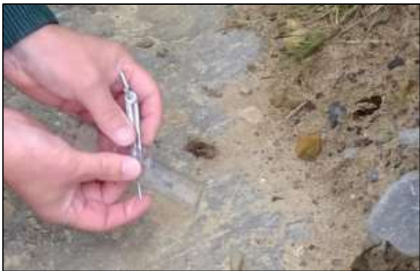
El mètode usant un compàs i un regle per mesurar la profunditat de les estries glaciars, Traeth Bychan, Anglesey, GB. (Peter i Maggie Williams).
