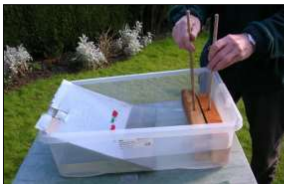
Foto 2: Simulación de una falla de desgarre desplazando bruscamente un bloque al lado del otro.
