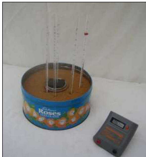
Montaje preparado para medir la velocidad de enfriamiento alrededor de una "intrusión" usando una lata de metal con tapa en el centro y cinco termómetros. (Mike Tuke).
