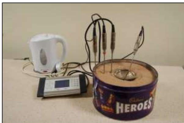
Montaje listo para medir la velocidad de enfriamiento alrededor de una "intrusión" de agua caliente usando un vaso de precipitados en el centro y una consola con 4 sensores. (Chris King).
