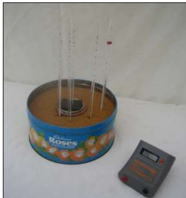
Muntatge preparat per mesurar la velocitat de refredament al voltant d'una "intrusió" usant una llauna de metall amb tapadora al centre i cinc termòmetres. (Mike Tuke).
