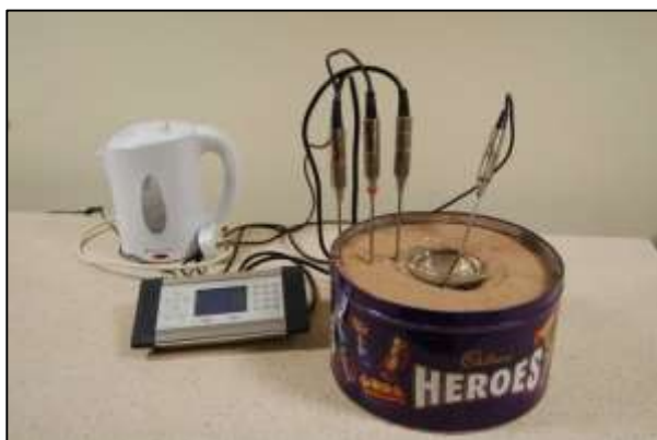
Muntatge preparat per mesurar la velocitat de refredament al voltant d'una "intrusió" d'aigua calenta usant un vas de precipitats al centre i una consola amb 4 sensors. (Chris King).
