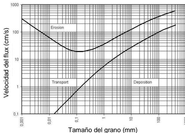
Diagrama de Hjulström-Sundborg que muestra las velocidades del flujo del agua que erosionan, transportan y sedimentan granos de tamaños diferentes
