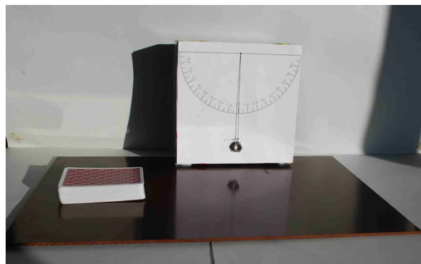
Figura 7a. Modellizzazione del cedimento nelle rocce incompetenti – scivolamento.
