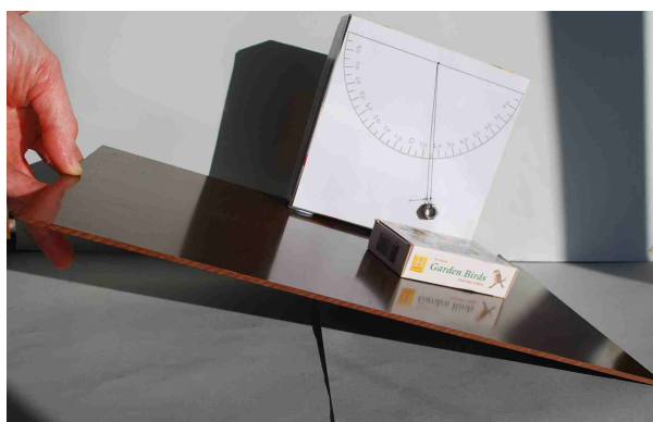
Figura 6b. Modellizzazione del cedimento nelle rocce competenti – scivolamento.
