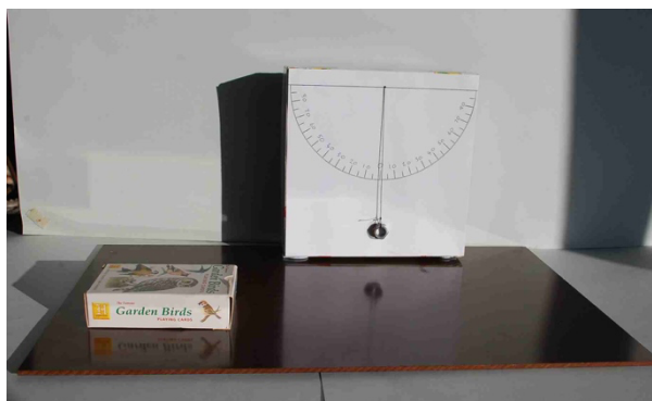
Figura 6a. Modellizzazione del cedimento nelle rocce competenti – scivolamento.
