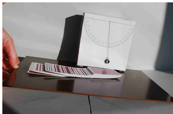
Figura 7b. Modellizzazione del cedimento nelle rocce incompetenti – scivolamento.
