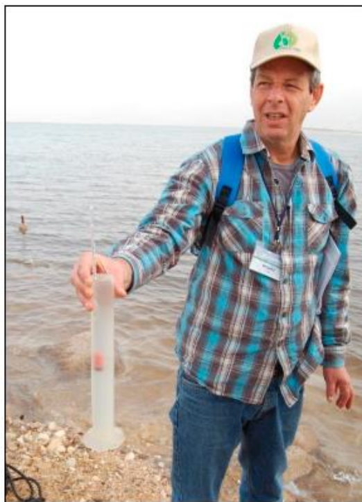
Científic mesurant la densitat de l'aigua salada de la Mar Morta per esbrinar quanta evaporació cal abans no comenci a cristal·litzar la sal de la dissolució. (Foto: Chris King)
