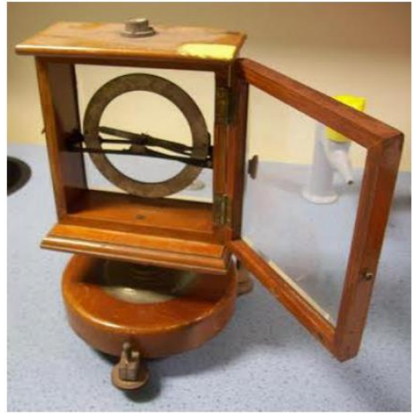
Un aparell, amb una agulla magnètica que gira en el pla vertical per mostrar la inclinació magnètica de la Terra (Foto: Suzy Allen/Gwyn Jones)
