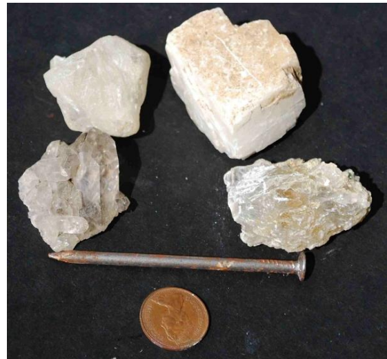
Dureza: fluorita, calcita, yeso y cuarzo con un clavo de acero y una moneda de cobre
