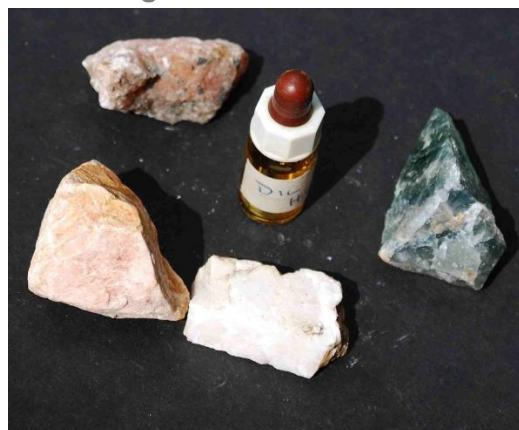
Prueba con ácido: yeso, fluorita, calcita, barita y un cuentagotas con ácido clorhídrico diluido
