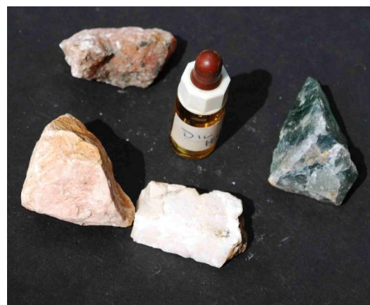
Prova amb àcid: guix, fluorita, calcita, barita i un comptagotes amb àcid clorhídric diluït
