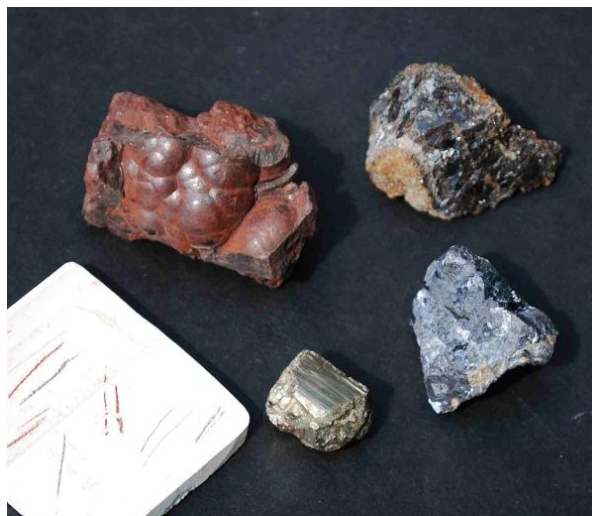
Ratlla: hematites, esfalerita, galena i pirita amb una placa de porcellana
