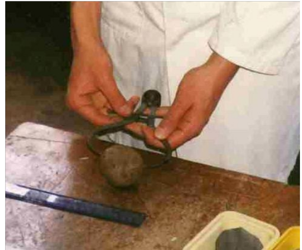
Medición del diámetro de la bola de arcilla antes de dejarla caer, usando un calibrador y una regla (Fotos: Peter Kennett )
