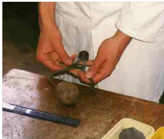
Mål leireklumpens diameter med et skyvelære eller en linjal før dere slipper den ned fra 2m over gulvet (Foto: Peter Kennett)
