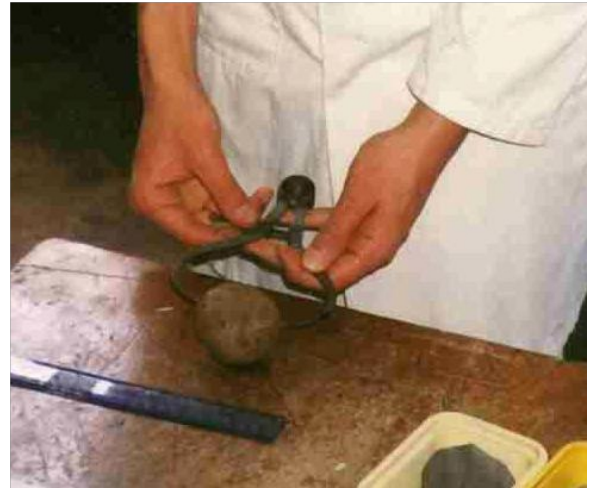
Mesura del diàmetre de la bola d'argila abans de deixar-la caure, usant un calibrador i un regle (Fotos: Peter Kennett)
