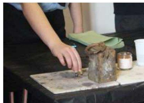
Pas 4: recollint els cristalls de ferro després d'haver-los triturat (Fotos: Heidi Dobbs, RSC)
