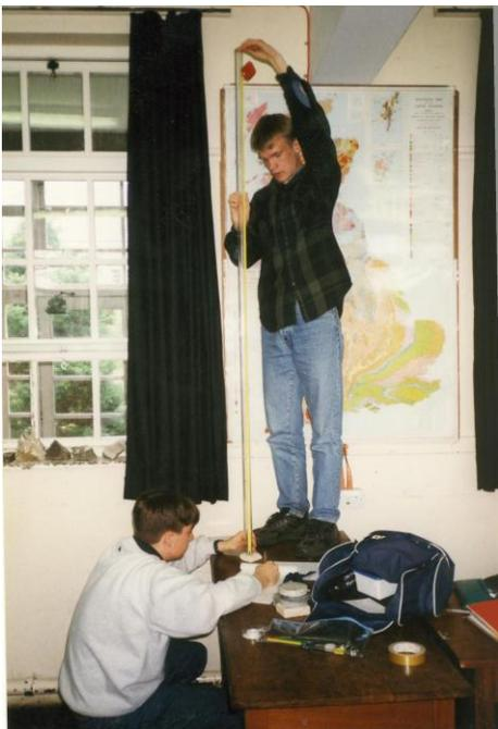
Estudiantes testeando el rebote de una bola de cojinete de una muestra de roca (usando un tubo de plástico de 2m de longitud)
