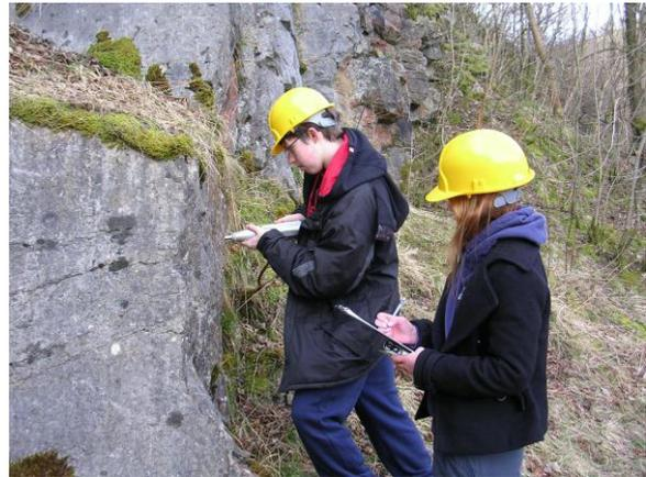
Estudiantes utilizando un Martillo Schmidt para medir la resistencia de una caliza como parte de un ejercicio de proyecto de un túnel
