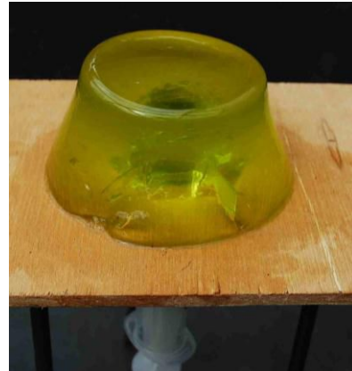
“Subsidència de caldera” després d'estirar l'èmbol dos o tres cops. També s'hi pot observar una fractura radial produïda quan s'empeny l'èmbol cap amunt.
