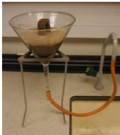
Un montaje muy básico para comprobar los efectos de la presión de agua en los poros sobre la resistencia de los sedimentos (Foto: Chris King)
