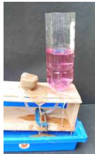
Unos segundos después de aflojar el sargento, el “edificio” se ha hundido a causa del aumento de la presión del agua en los poros de la arena
