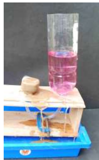
Uns segons després d'afluïxar el serjant, "l'edifici" s'ha ensorrat a causa de l'increment de la pressió d'aigua als porus de la sorra
