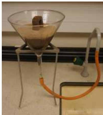
Un muntatge molt bàsic per comprovar els efectes de la pressió d'aigua als porus sobre la resistència dels sediments (Foto: Chris King)
