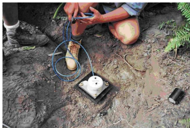
Clinòmetre en funcionament a l'illa volcànica de Montserrat
