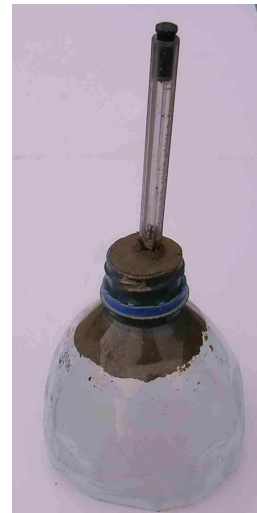
Embudo casero construido con una tapa de botella plástica, el tubo de un bolígrafo y algo de masilla. (Fotos: P. Kennett)
