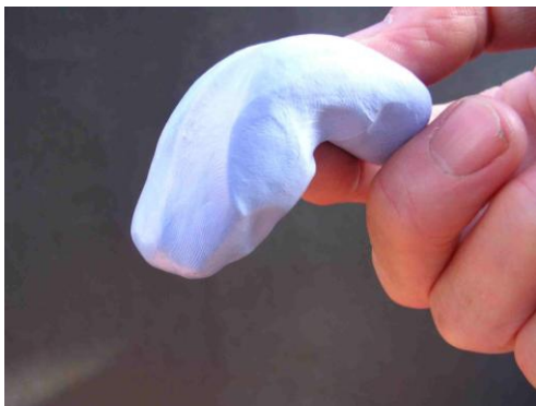
Deformación plástica por su propio peso
