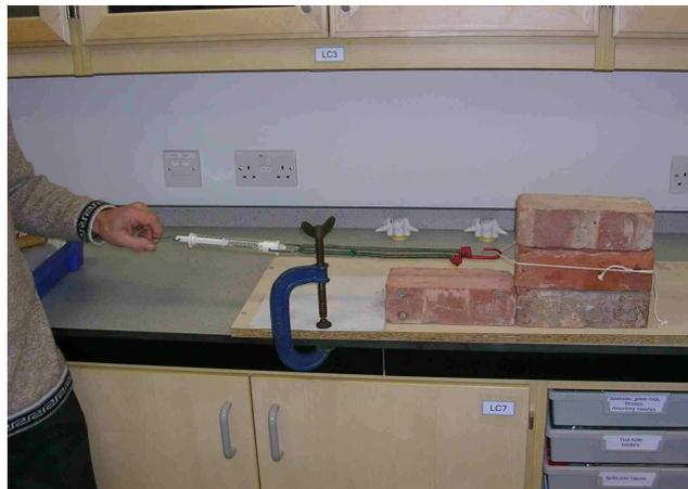
Los ladrillos sísmicos en acción – b) Utilizando un dinamómetro para medir las fuerzas involucradas. El ladrillo de la base se fijó con una prensa C. (Fotos: P. Kennett)
