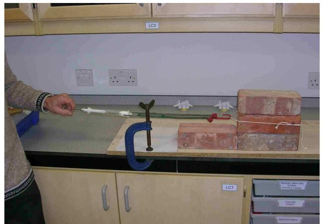
Il mattoncino "terremoto" in azione – b) Usate un dinamometro per quantificare le forze coinvolte. Una tavola fissata al banco di lavoro con un morsetto impedisce lo scivolamento del mattoncino anteriore. (Foto: P. Kennett)
